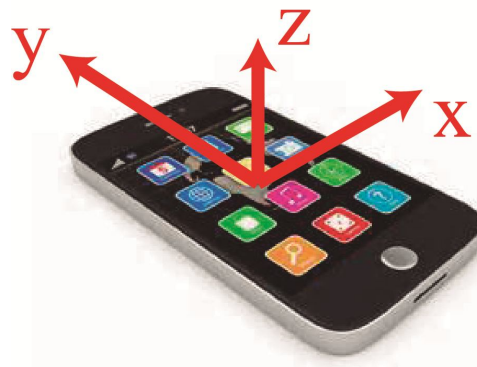
Figura 3. Orientación de los ejes espaciales en un smartphone
