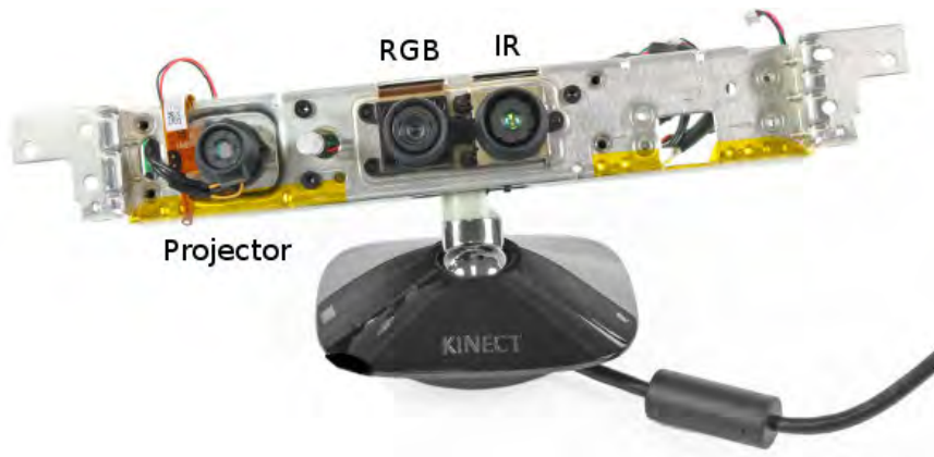
Figura 2.11: Componentes del sensor Microsoft Kinect
