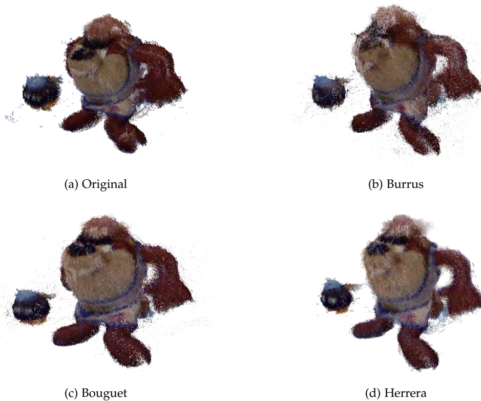
Figura 3.31: Perspectiva de los diferentes registros obtenidos con el sensor Microsoft Kinect
