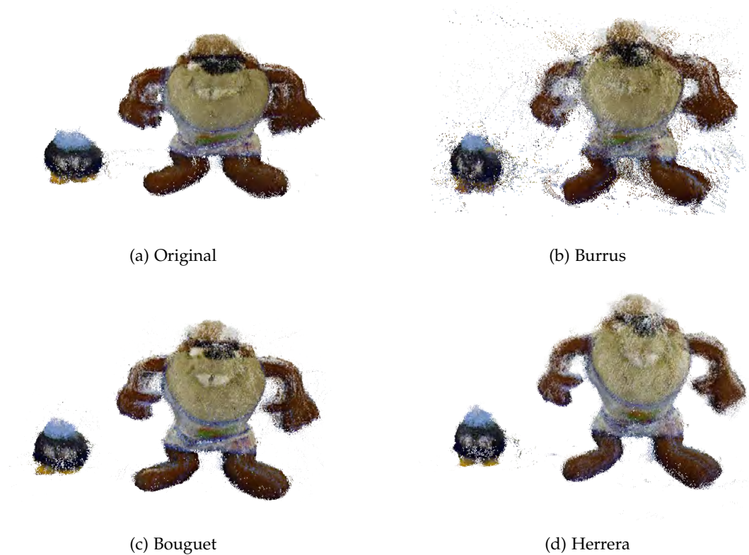
Figura 3.30: Vista frontal de los diferentes registros obtenidos con el sensor Carmine 1.09
