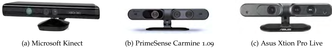
Figura 2.16: Sensores RGB-D que utilizan luz estructurada para determinar la profundidad
