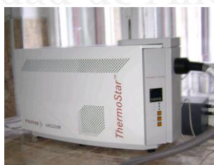
Figura 2.13. Espectrómetro de masas empleado para los experimentos de adsorción de hidrocarburos en condiciones en arranque en frío.
