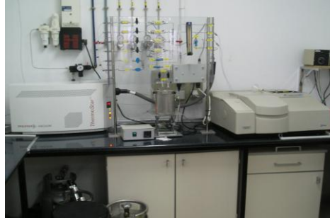
Figura 2.10. Sistema experimental empleado para llevar a cabo los ensayos de DRIFT in-situ .
