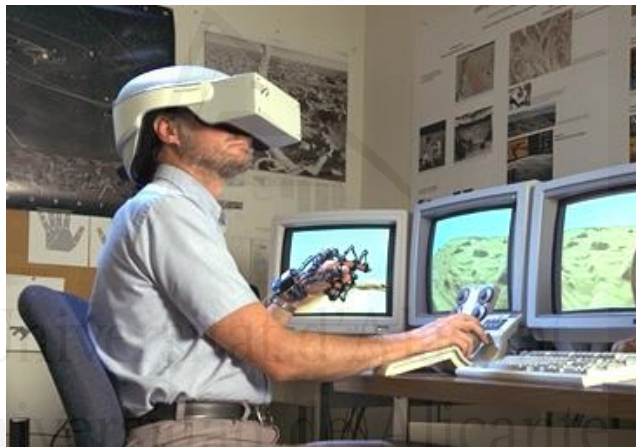
Figura 2: Sistema de realidad virtual con HMD y guante virtual
