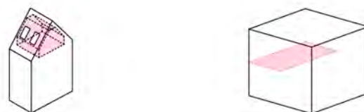
Fig. 3. Crecimiento por ocupación bajo cubierta y creación de nuevos forjados.
