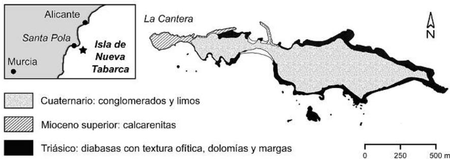
Fig. 1.- Localización y cartografía geológica de la isla de Nueva Tabarca.
