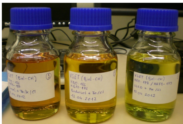
Figura 7. Diésel y biodiésel utilizados en el motor Liebherr.
