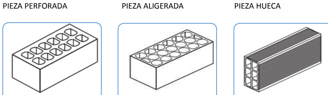
Figura 8. Clasificación de piezas en España. Fuente: elaboración propia a partir de los datos (Vega Catalán, y otros, 2008)
