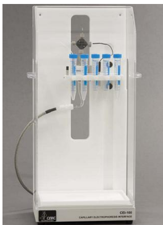
Figura V.7: Interfase CE-ICP con flujo líquido auxiliar modelo CEI-100 de la casa comercial CETAC Technologies [16].
