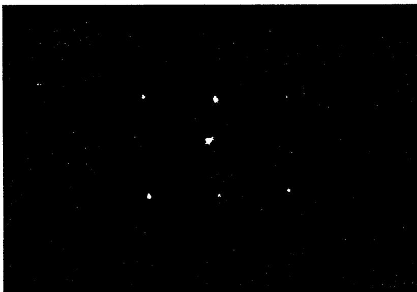
Figura 4.30. Figura de difracción LEED (110)-(1x1) de un electrodo Pt(110) tras la adsorción y oxidación de CO (a altos recubrimientos) sobre Pt(110)-(1x2) y emersión a 0.43V. 44V, 90s.
