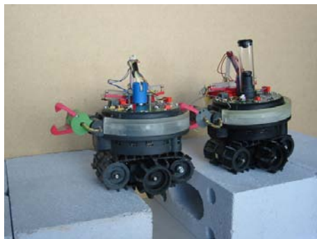
Figura 2.1: Configuración del swarm-bot para cruzar un hueco. Imagen obtenida de http://www.swarm-bots.org (consultada en noviembre de 2013).
