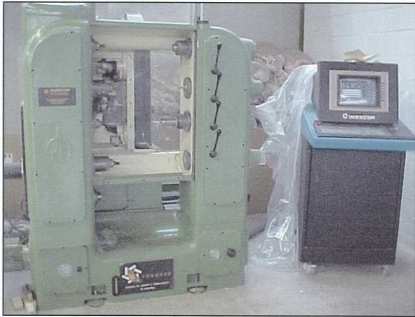
Fotografía 4.3: Torno de mecanización de hormas de dos pares controlado por computador. Puede apreciarse, como principal diferencia con el torno tradicional, la ausencia en su parte inferior del elemento copiado.
