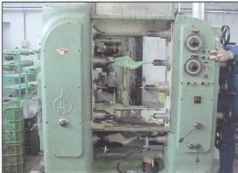
Fotografía 4.2: Torno tradicional para el mecanizado de hormas de calzado: en la parte superior, horma de polietileno verde en fabricación; en la parte inferior, horma original de madera sobre el elemento copiador.
