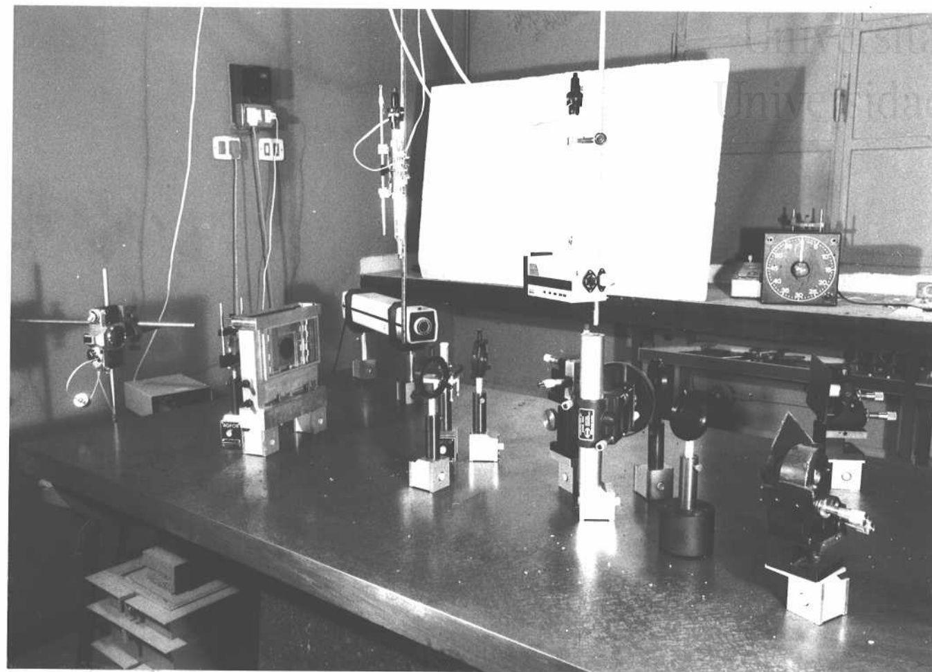
Fig. 3.4 Montaje óptico utilizado para interferometría holográfica en tiempo real.
