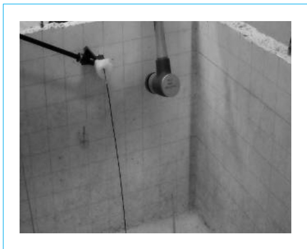
Figura 3. Medida del tiempo de reverberación estructural en una maqueta a escala de hormigón
