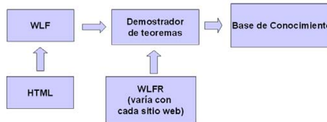
Figura 2: Esquema del proceso de extracción de la estructura lógica de un sitio web
