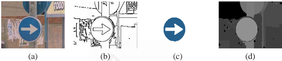
Figura 1.6: (a) Imagen de referencia. (b) Segmentación. (c) Resultado de la detección. (d) Mapa de disparidad.
