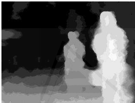
Figura 2.2: Imagen de disparidad obtenida a partir del par de imágenes de la figura 2.1
