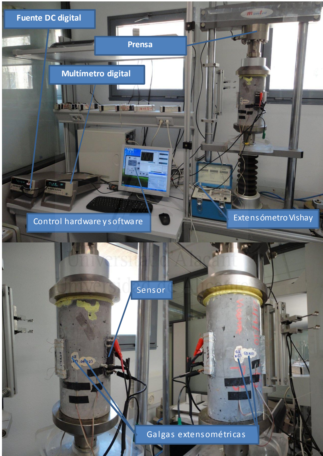
Figura 6-21. Montaje experimental y disposición de sensor y galgas en probeta.
