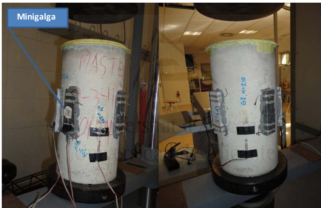
Figura 6-22. Disposición de sensores y galgas extensométricas en una de las probetas. A la izquierda se muestra la mini-galga adherida a un sensor.
