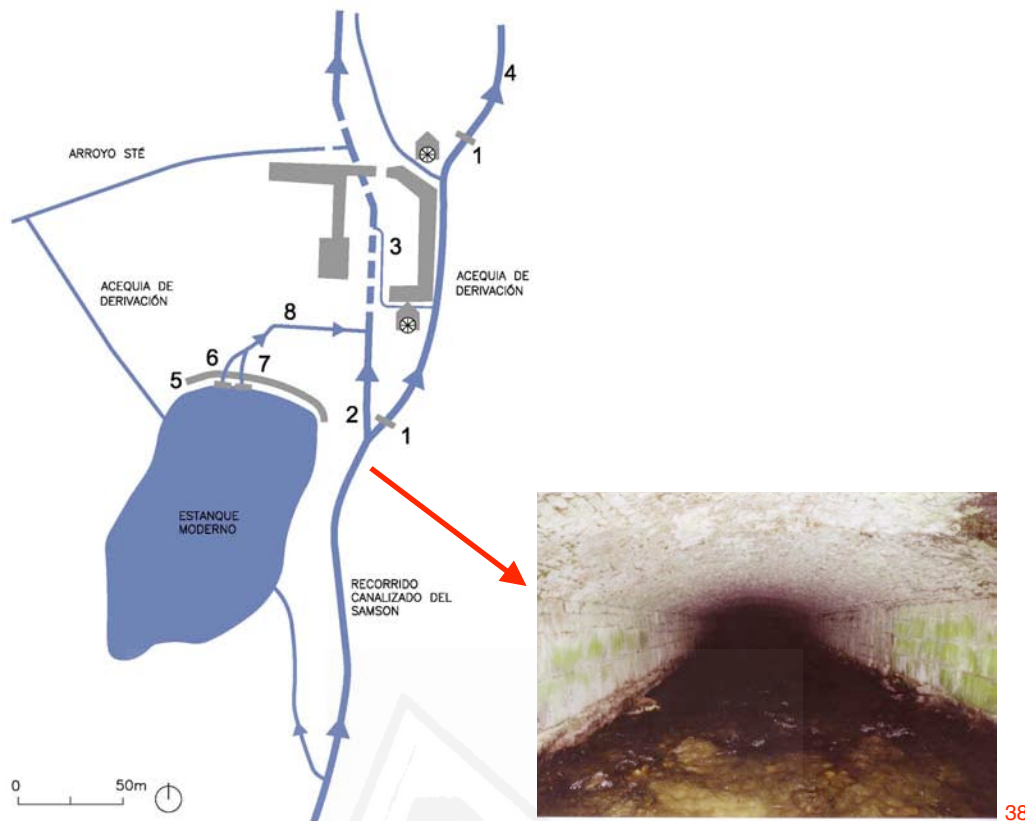
Grandpré: 1 compuertas, 2 salto de agua, 3 canalización subterránea, 4 antiguo canal de irrigación, 5 dique, 6 compuerta de desagüe, 7 aliviadero, 8 canal de evacuación. Dcha. canalización subterránea del Samson.
