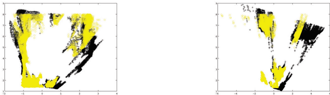
Figura 5: Dos conjuntos de puntos tras la transformación de la odometría. Se puede observar, debido al campo de visión de la cámara, la presencia de gran cantidad de outliers .
