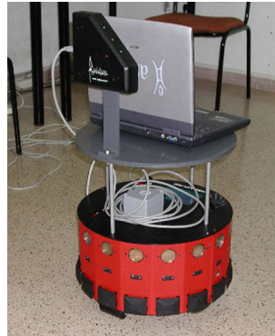
Figura 1: Robot utilizado en los experimentos con la cámara triestéreo utilizada.
