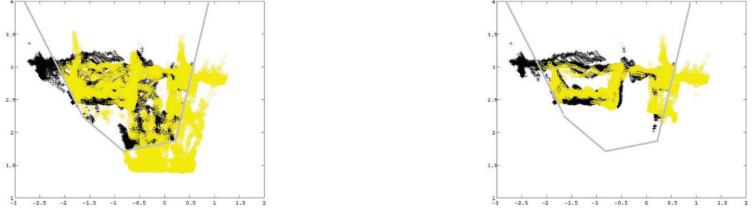
Figura 6: Restricción del campo de visión de la cámara y eliminación de puntos del suelo y techo. Los puntos fuera del campo de visión de las cámaras (líneas grises) no se tienen en cuenta para el cálculo.
