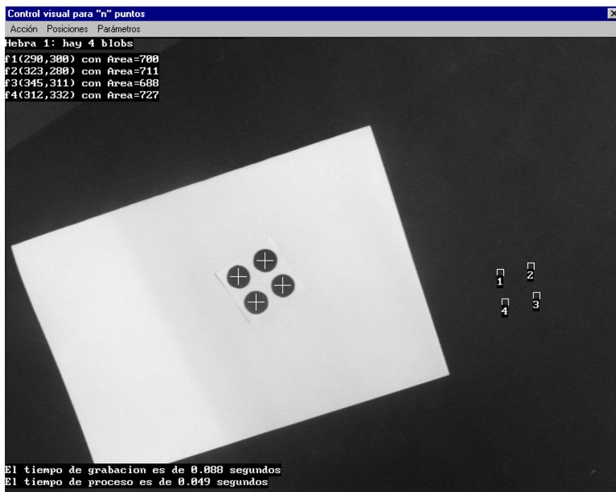
Figura 2-27. Detección de los puntos característicos. Estado previo al control visual.
