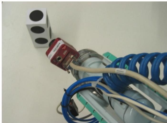
Figura 5-8. Configuración de la cámara eye-in-hand para las pruebas.
