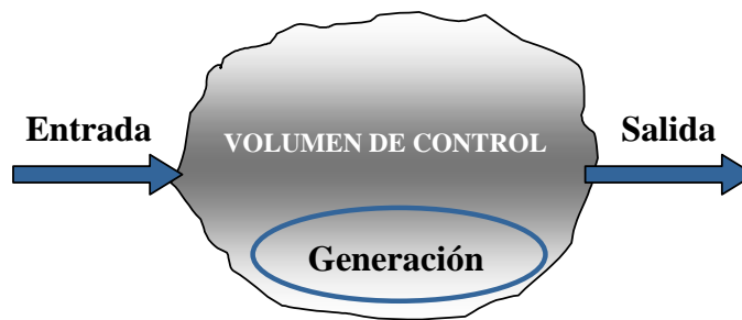
Figura 1. Volumen de control establecido para aplicar el balance de materia a un cuerpo de agua natural donde se produce un vertido.
