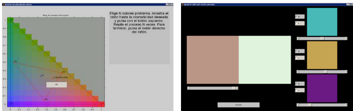
Fig. 3: (izq) Pantalla para la selección gráfica del color problema. Después de seleccionar la cromaticidad, el programa pide el valor numérico de la luminancia. (drch) Pantalla para la determinación de los valores triestímulo, análoga a la usada para las unidades tricromáticas.
