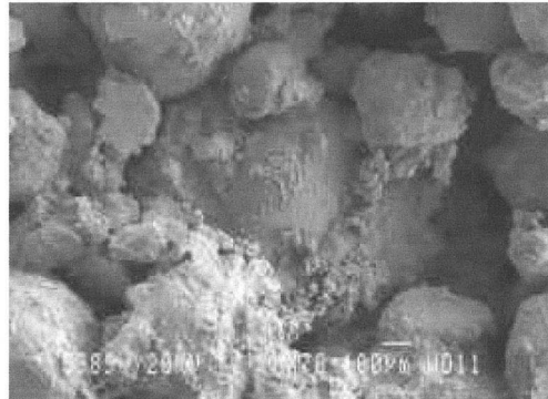
Fig. 6.- Fotomicrografía realizada en el MEB en modo de electrones secundarios mostrando el aspecto general del mortero
