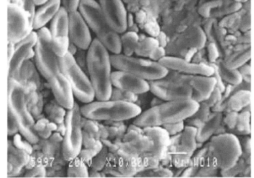
Fig. 8.- Fotomicrografía realizada en el MEB-ES de la cubierta biológica de un prefabricado
