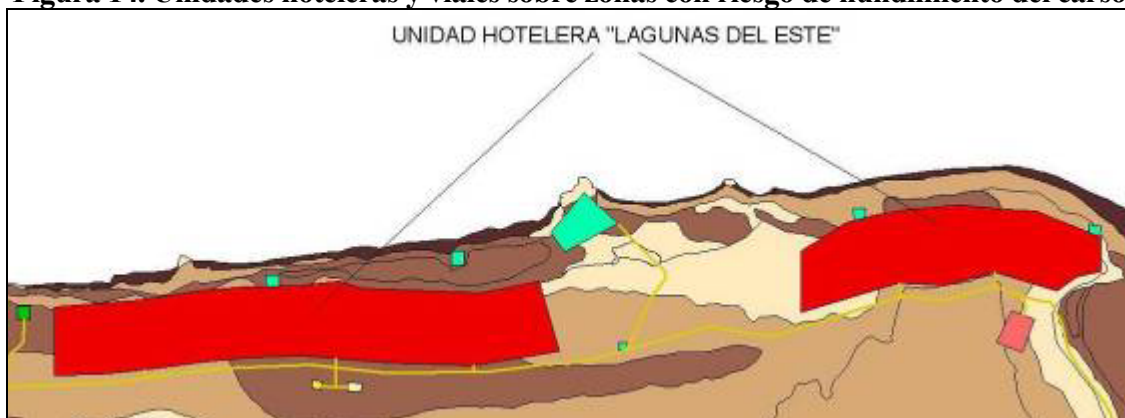
Figura 14. Unidades hoteleras y viales sobre zonas con riesgo de hundimiento del carso.
