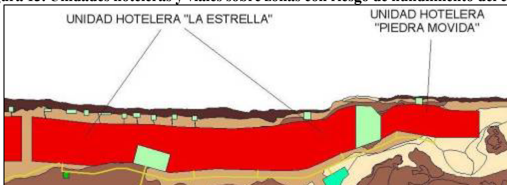
Figura 13. Unidades hoteleras y viales sobre zonas con riesgo de hundimiento del carso.
