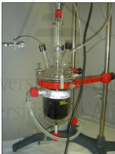
Figura 2.2. Reactor utilizado en la reacción de eliminación de nitrato.
