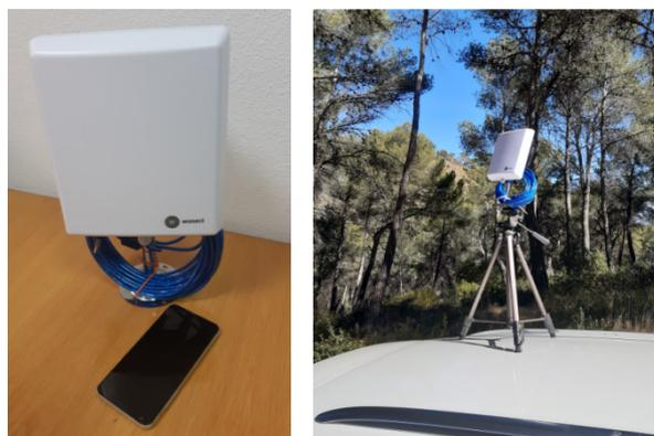
Figura 3. Terminal AVANZA y uso en pruebas.
