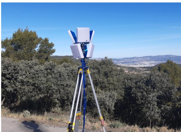
Figura 5. Repetidor de largo alcance usado en pruebas.
