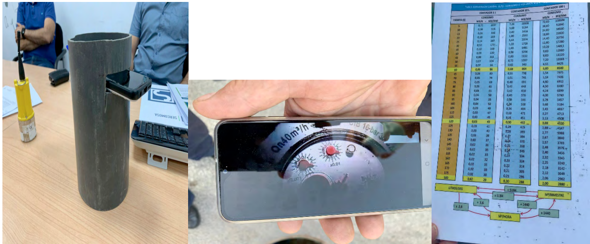
Figura 6. Sistema para videolectura contador sector y tabla conversión de caudal.
