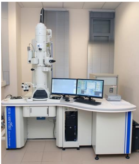
Figura 2.11. Imagen del microscopio TEM JEOL modelo JEM-1400 ubicado en los servicios técnicos de investigación de la Universidad de Alicante.
