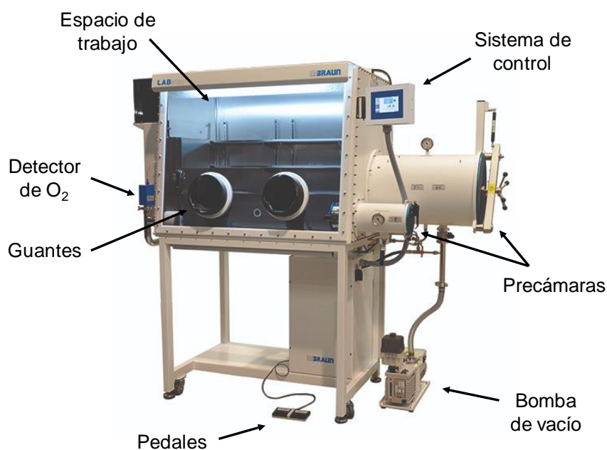
Figura 2.7. Caja de guantes MBraun modelo LabStar. Imagen adquirida de la página oficial de MBraun.
