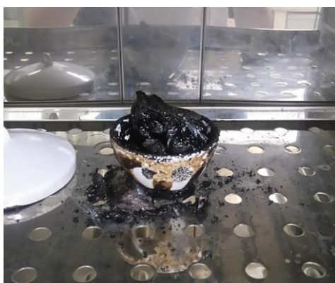
Figura 2.1. Paso intermedio de la síntesis de la espinela MgMn_2O_4 después del tratamiento térmico a 200°C durante 12 horas.
