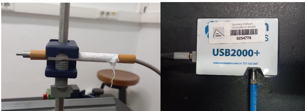
Figura 9. Fibra óptica de 600 \mu\text{m} de diámetro y espectrofotómetro USB 2000+ de la casa OCEAN OPTICS.
