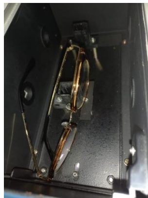
Figura 11. Filtro óptico-analógico montado en gafa ATTCL en el espectrofotómetro de doble haz.
