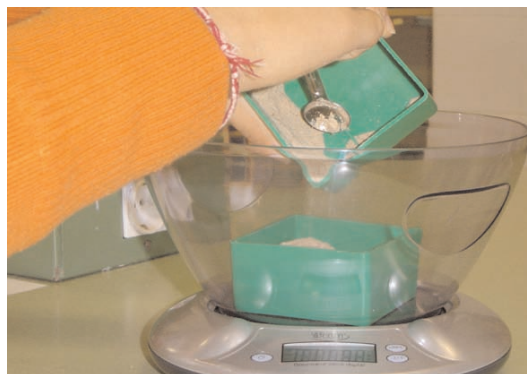
Fig. 10. Procedimiento para conseguir la densidad establecida para las cajas de plástico.
