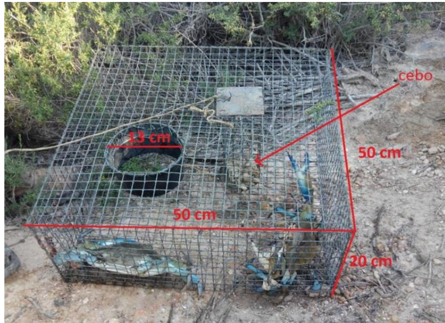
Figura 10. Imagen de las nasas utilizadas en el estudio hechas de malla metálica con abertura superior y con lastre para evitar que sea arrastrada por la corriente. Fuente: foto enviada por la tutora María del Carmen Barbera Cebrián y esta foto fue fotografiada por Isa Estesó (25/06/2018).
