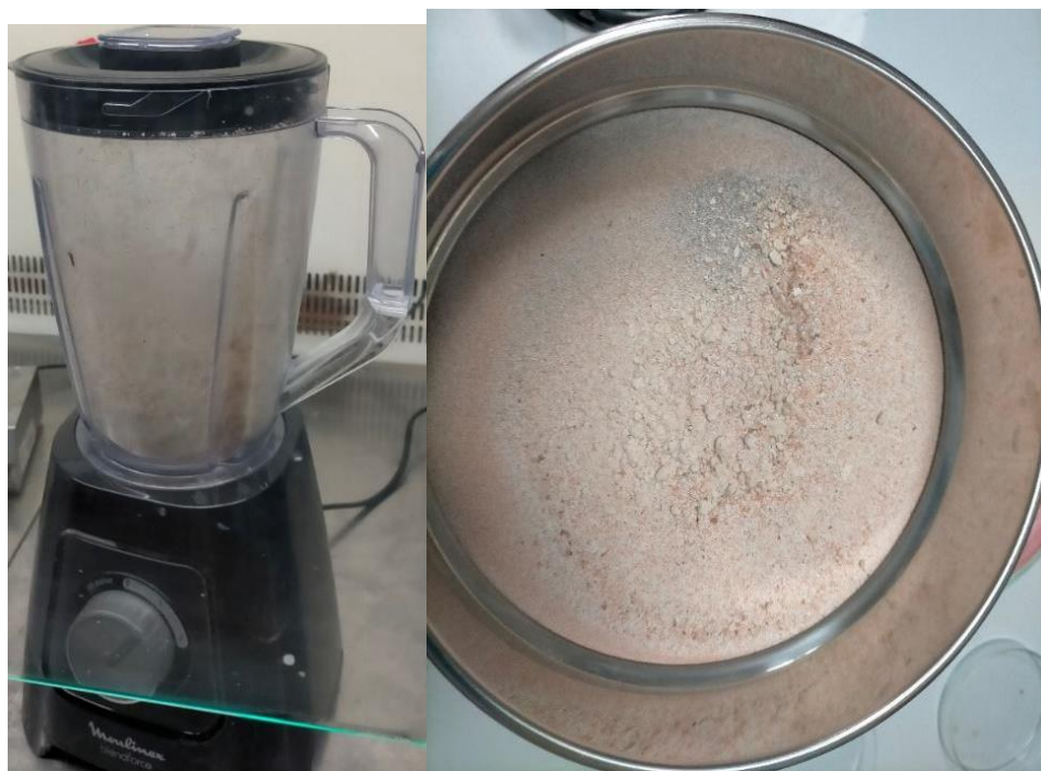
Figuras 14 y 15. Imagen de la batidora (Figura 14.), donde fueron triturados los restos de exoesqueletos de los cangrejos azules ( Callinectes sapidus ) e imagen de los tamices (Figura 15.) junto con las muestras siendo tamizadas.
