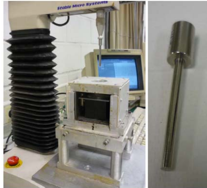
Figura II.19. Equipo Texture Analyzer TA.XT2i (izquierda) y vástago usado para medir la pegajosidad (derecha).
