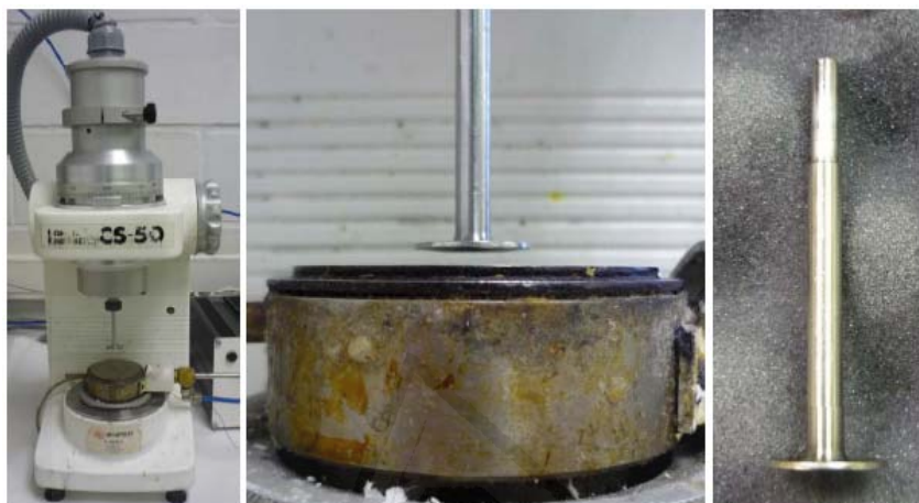
Figura II.15. Reómetro Bohlin CS50 (izquierda), plato Peltier (centro) y vástago LNG SFT PP20 (derecha).
