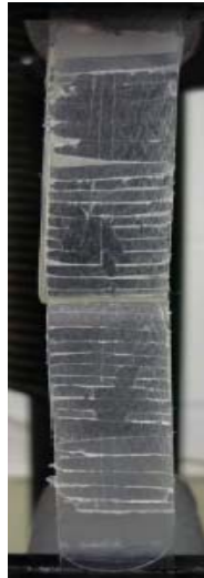
Figura III.1.7. Aspecto de una unión film de polipropileno-adhesivo-film de polipropileno que presenta fallo de adhesión de tipo stick-slip .
