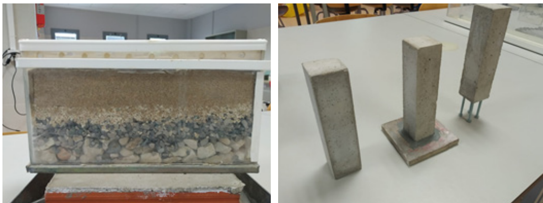
Figura 1. Izquierda: Urna transparente de metacrilato con las gravas y arenas. Derecha: Modelos de edificaciones con distinta tipología de cimentación.
