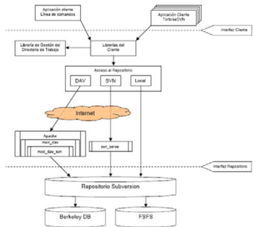
Figura 1. Arquitectura y Estructura de los módulos de Subversion obtenida de [8].
