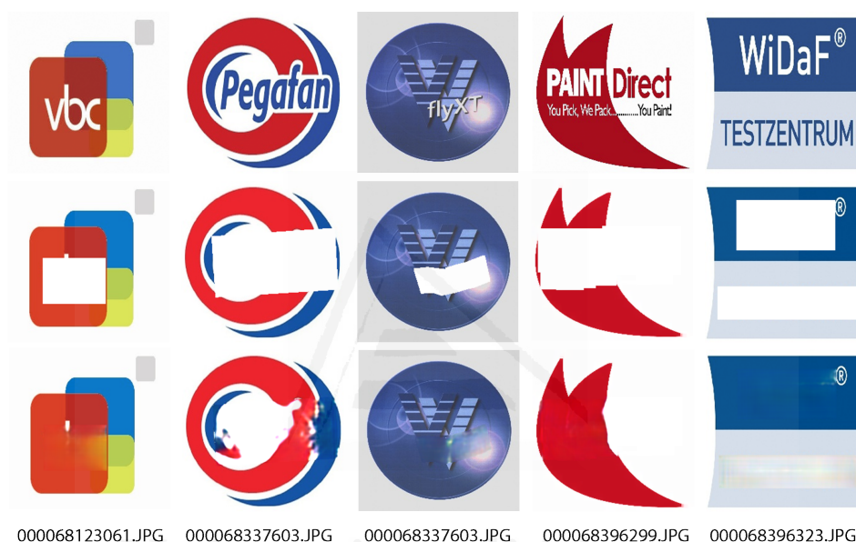
Figura 5.4.: Ejemplo de preproceso: la primera fila muestra el logo original, en la segunda se puede ver cómo se elimina el texto seleccionado en la imagen mediante el método CRAFT y, por último, en la tercera fila se ilustra cómo se rellena el hueco del texto detectado usando para esto una red neuronal de inpainting .
