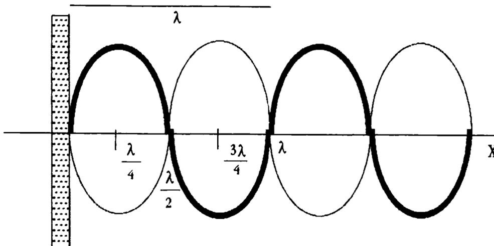
Consideremos ahora una cuerda con sus dos extremos fijos. Una onda armónica producida por cierta perturbación en uno de sus puntos se propagará a lo largo de la cuerda reflejándose en las paredes e interfiriendo con las ondas reflejadas.
