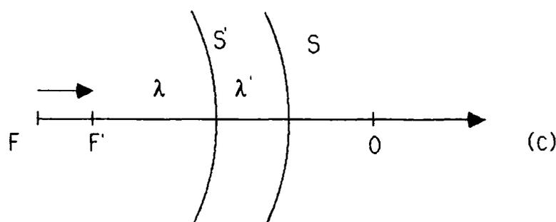
Un foco emisor (F) en su vibración, perturba el ambiente (a) y la superficie de onda originada (S) se propaga en un periodo una distancia  $\lambda = v_s T$  donde  $v_s$  es la velocidad de propagación del
