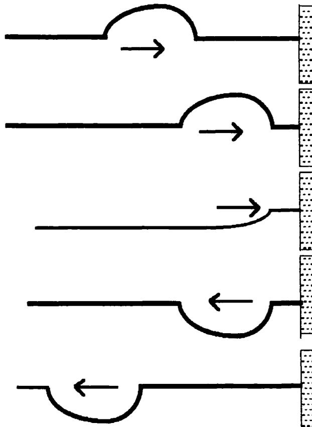
Las leyes de Newton explican este comportamiento. Cuando el pulso llega al extremo fijo, la tensión de la cuerda produce una fuerza hacia arriba sobre la pared, de masa infinita y, por tanto, inmóvil. Por el principio de acción y reacción, la pared produce una fuerza igual, pero hacia abajo, sobre la cuerda, que invierte el pulso, comenzando su propagación en sentido contrario.
