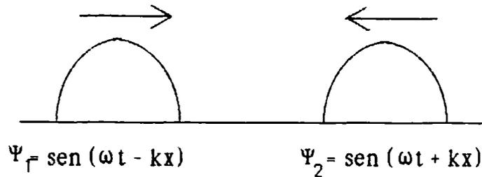
Consideremos a continuación la situación en la cual la cuerda tiene uno de sus extremos fijos (0) y el otro libre, en el cual se produce una perturbación armónica. Esta onda se desplazará hacia la pared (onda incidente), donde dará lugar a la onda reflejada, con la que interfiere.
