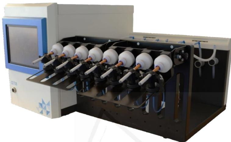
**Figura 1.14.** Máquina de fumar lineal de la marca Cerulean con 8 puertos.
