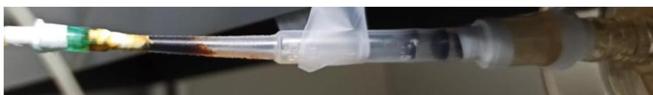
**Figura 3.20.** Condensación de la TPM utilizando un estrechamiento en la conducción.
