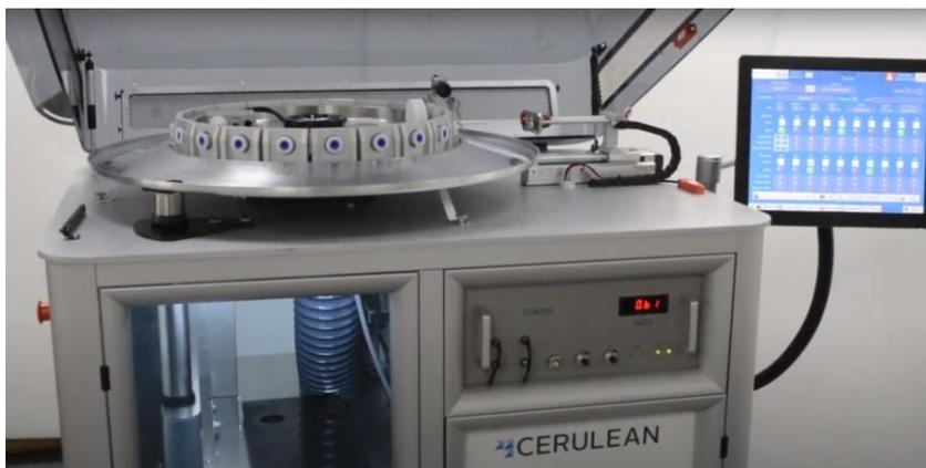
**Figura 1.15.** Máquina de fumar lineal de la marca Cerulean con 20 puertos.
