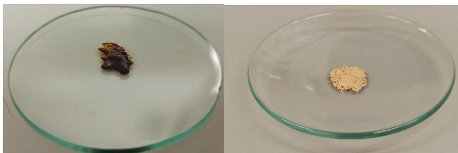
**Figura 3.21.** TPM total obtenido del experimento de fumado y su mezcla con catalizador.
