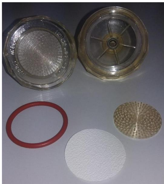
**Figura 3.17.** Portafiltros (Plastic filter holder FP 050/01) y filtro tipo Cambridge utilizados en los experimentos de fumado.
