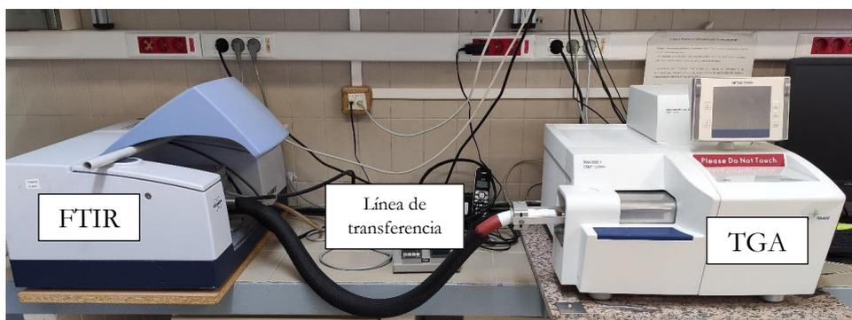
**Figura 3.10.** Termobalanza TGA/DSC 1 STARe System acoplado al espectrómetro Tensor-27.
