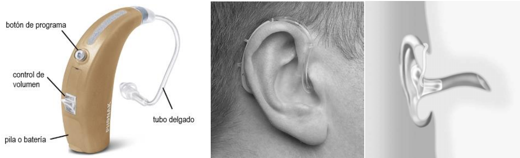
Figura 16. Imagen audífono digital BTE. Adaptado de “Hearing aids” por R. Hampson (2012), European Geriatric Medicine , 3(3), p. 199
