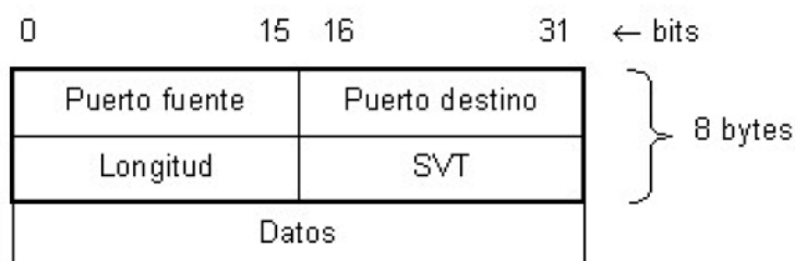
Figura 8. Formato de la cabecera del protocolo UDP.
