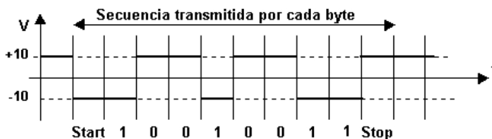
Figura 10. Formato de transmisión en una línea serie asíncrona.
