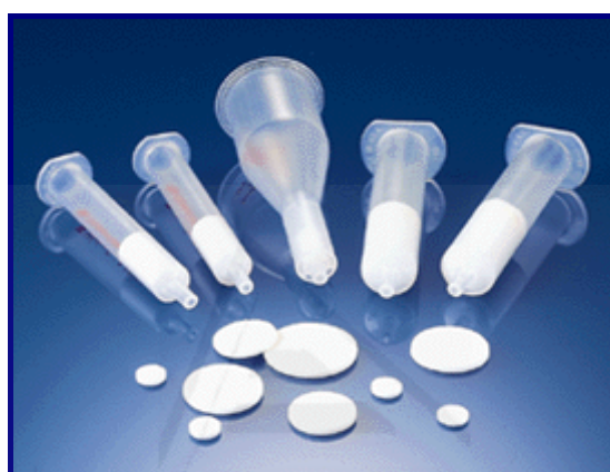
Figura 14. Cartuchos y discos empleados en la extracción en fase sólida. (Fuente: www.genopore.com )
