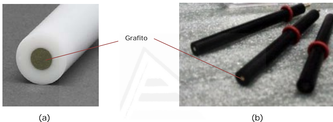
Figura 50 . Electrodos de trabajo. (a) Grafito pirolítico; (b) carbón vítreo.
