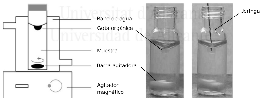
Figura 34. Esquema de la DSDME. (Fuente: referencia 82).
