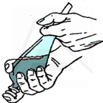
Figura 20. Extracción líquido-líquido convencional mediante agitación en embudo de decantación.
