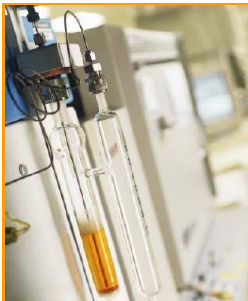
Figura 7. Sistema comercial de purga y trampa. (Fuente: www.restekcorp.com ).
