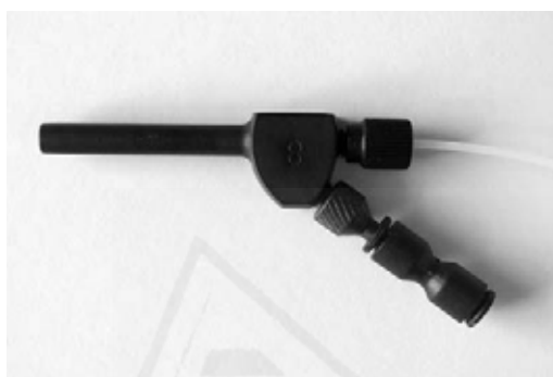
Figura IV.1-5. Nebulizador NNFF basado en el quinto diseño.
