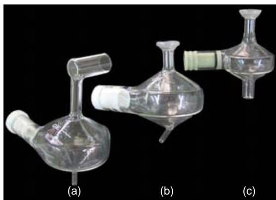
Figura I.2-43. Cámaras de nebulización ciclónicas de vidrio de diferentes volúmenes internos: (a) 50 mL; (b) 44 mL; (c) 20 mL.
