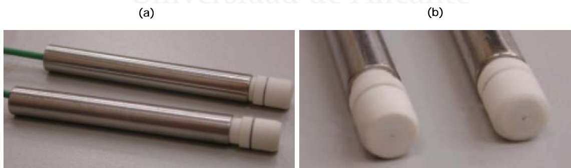
Figura IV.1-2. (a) Tercer diseño del NNFF; (b) detalle de la punta del tercer diseño NNFF.
