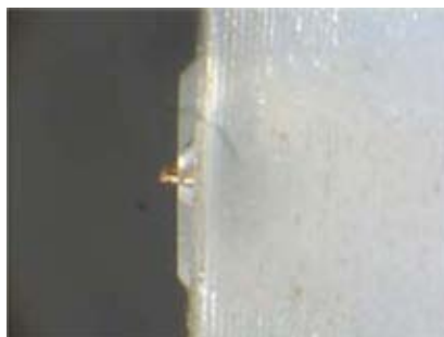
Figura I.2-32. Detalle de la punta de un nebulizador microconcéntrico (tomado de la referencia 159).
