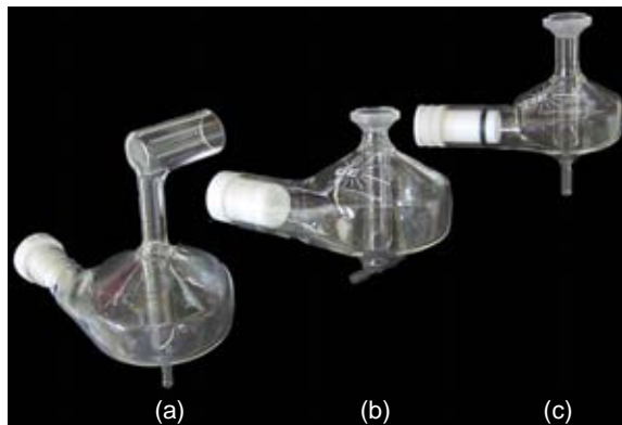
Figura I.2-44. Cámaras de nebulización ciclónicas con tubo en el interior de vidrio de diferentes volúmenes internos: (a) 50 mL; (b) 44 mL; (c) 20 mL.
