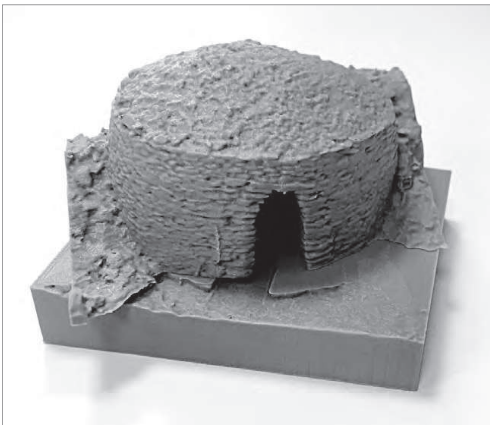
Figura 7. Modelat tridimensional del cuco realitzat amb impressora 3D
