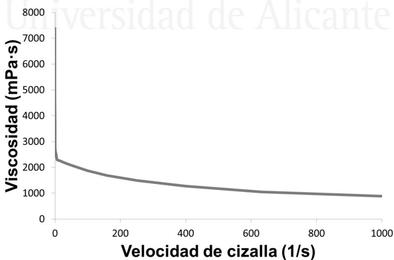
Figura B.2-42. Variación de la viscosidad (25 °C) frente a la velocidad de cizalla de la dispersión acuosa de poliuretano del experimento FFD6 en el diseño factorial completo con puntos centrales.
