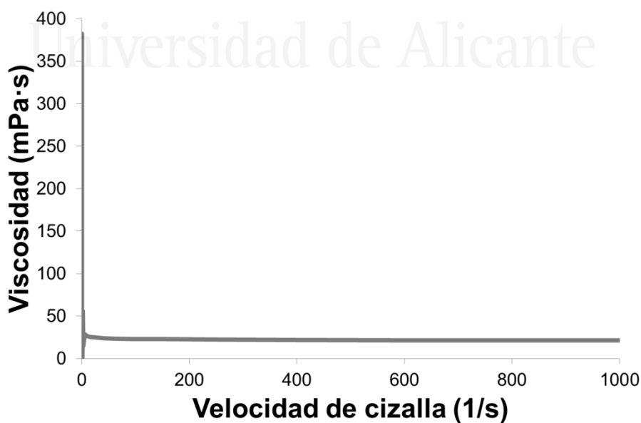
Figura B.1-9. Variación de la viscosidad (25 °C) frente a la velocidad de cizalla de la dispersión acuosa de poliuretano del experimento S2 en el diseño factorial fraccional.
