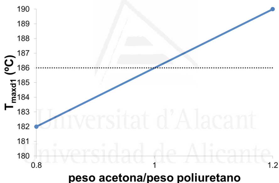
Figura 3.41. Gráfico de efectos principales donde se muestra el valor T_{\max d1} de las películas de poliuretano con respecto a la cantidad de acetona (A).
