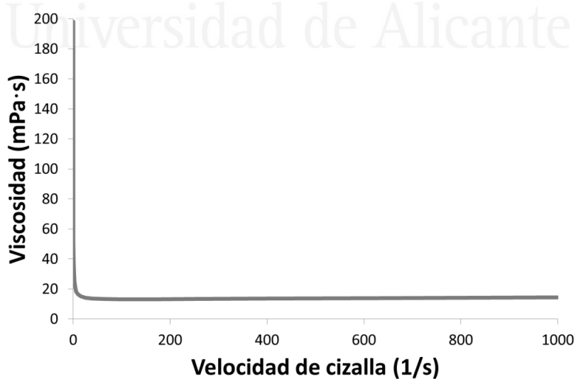
Figura B.2-2. Variación de la viscosidad (25 °C) frente a la velocidad de cizalla de la dispersión acuosa de poliuretano del experimento FFD1 en el diseño factorial completo con puntos centrales.
