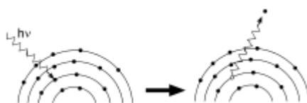
Figura 2.1: Representación esquemática del proceso de extracción de un electrón de un átomo como consecuencia de la irradiación de un haz de rayos-X.
