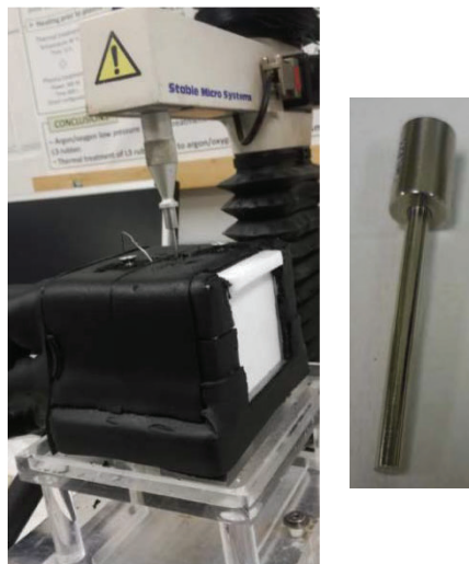
Figura II.14. Equipo Texture Analyzer TA.XT2i (izquierda) y vástago usado para medir la pegajosidad (derecha).
