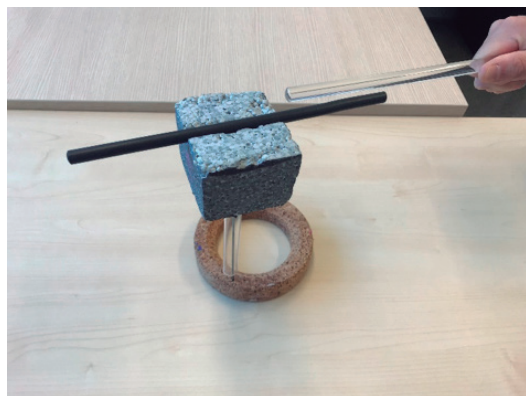
Imagen 3. El versorio permite detectar fuerzas atractivas y repulsivas con gran claridad. Puede colocarse la varilla electrizada sobre la base de porespán y acercarlo a objetos grandes o inmóviles
