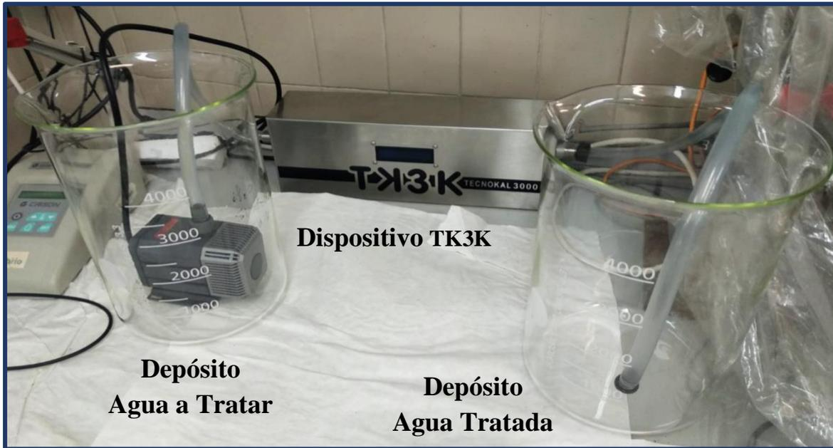
Figura 11: Planta piloto de tratamiento magnético (Imagen Propia).
