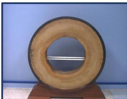
*Figura 1: Tubería de fundición de 600 mm de diámetro interior reducida casi en un 50% debido a incrustaciones (izquierda) (Richard, 2019).*
