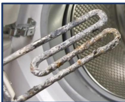
*Figura 2: Incrustaciones formadas en la resistencia de una lavadora doméstica (derecha) (“CWT International”)*
