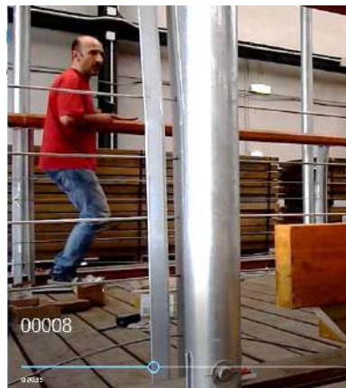
Figura 2. Detalle de cómo se excita de la estructura mediante la placa de fuerza
