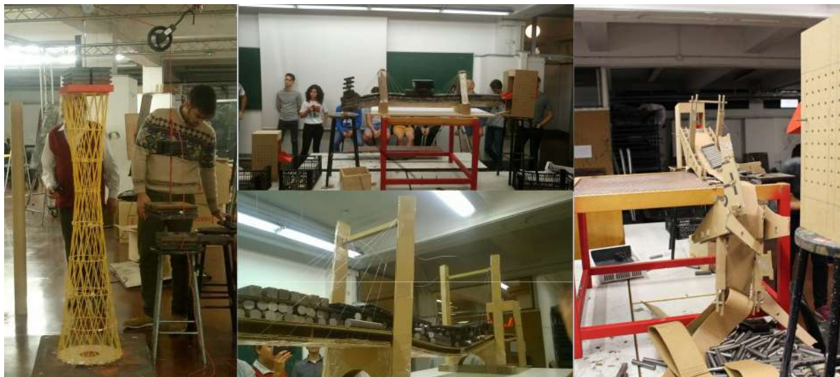
Figura 1: Carga hasta rotura de algunas de las construcciones propuestas en el taller: Torre de spaghetti, y varios ejemplos de puente atirantado.
