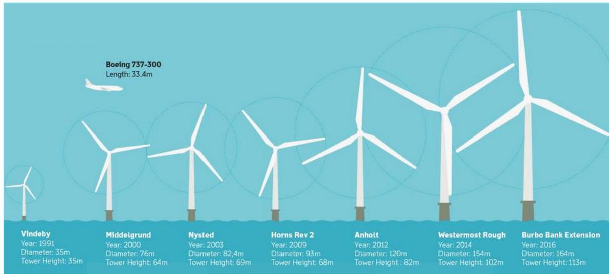
**Fig. 3.** Evolución en tamaños y potencias desde 1991 hasta la actualidad. Las alturas se han multiplicado por 3, los diámetros de las palas por 5, y las potencias unitarias por 18. Fuente: DONG ENERGY.
